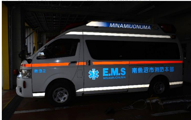
図2 従来と比較し反射ラインを増強した高規格救急自動車
